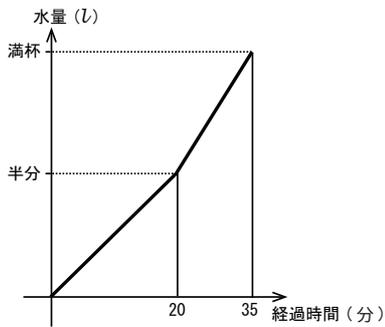
注入口から1分間に注入される水量  $[l]$  を  $a [l/\text{分}]$ 、排水口から1分間に排出される水量  $[l]$  を  $b [l/\text{分}]$  とする。20分経過して見にいたらタンクに水が半分溜まっていたことから、 $a > b$  である。左図のように、この20分間は排水口が開いていたために、1分間に注入される水量は  $(a - b) [l/\text{分}]$  となり、タンク容量  $T [l]$  の半分を満たしていたということから
